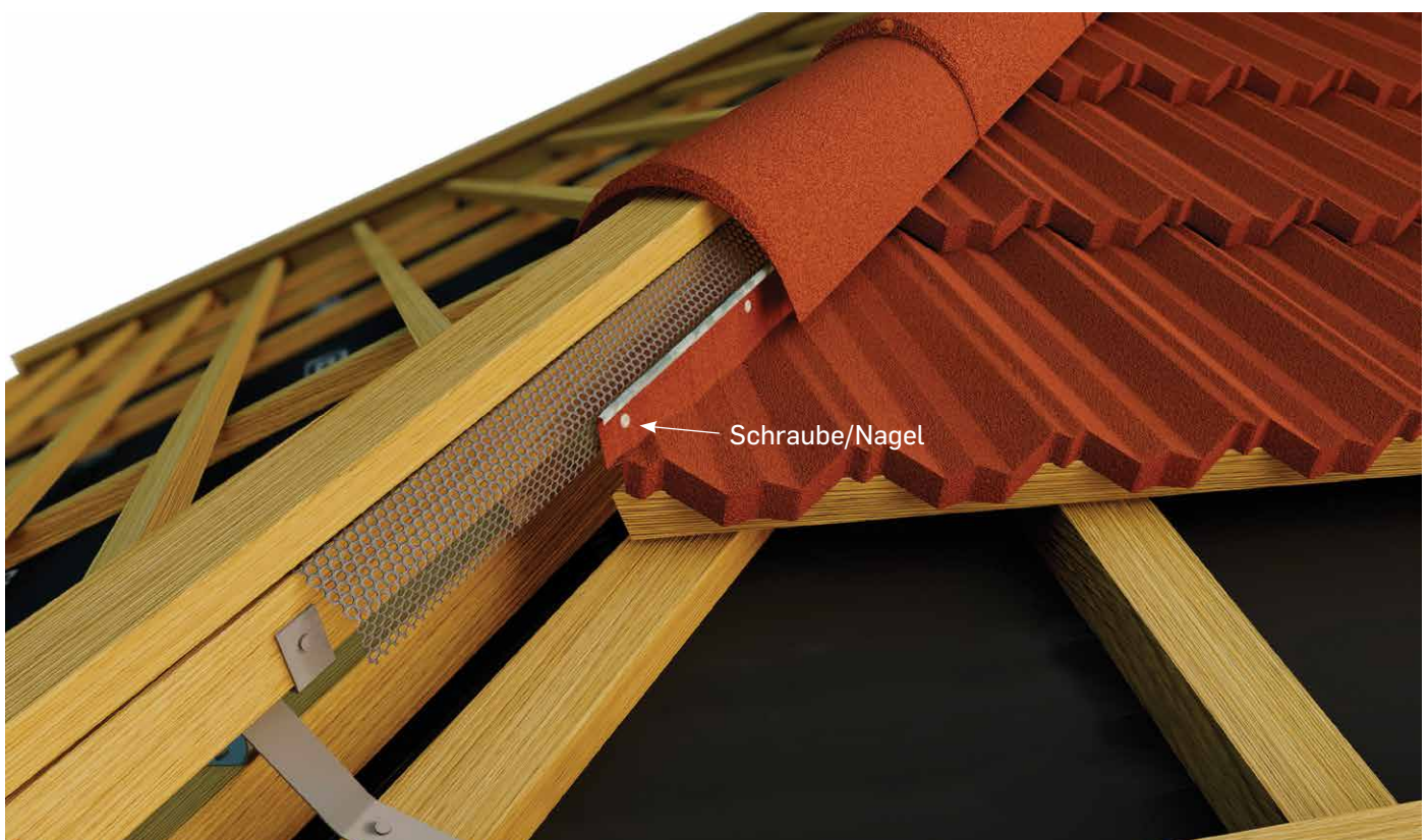
Option 1: Gratlatte mit Lüftungsgitter
