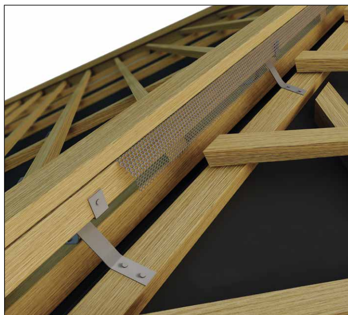
Option 1: Gratlatte – Befestigung auf die Gratlattenhalter und Montage eines Lüftungsgitters
