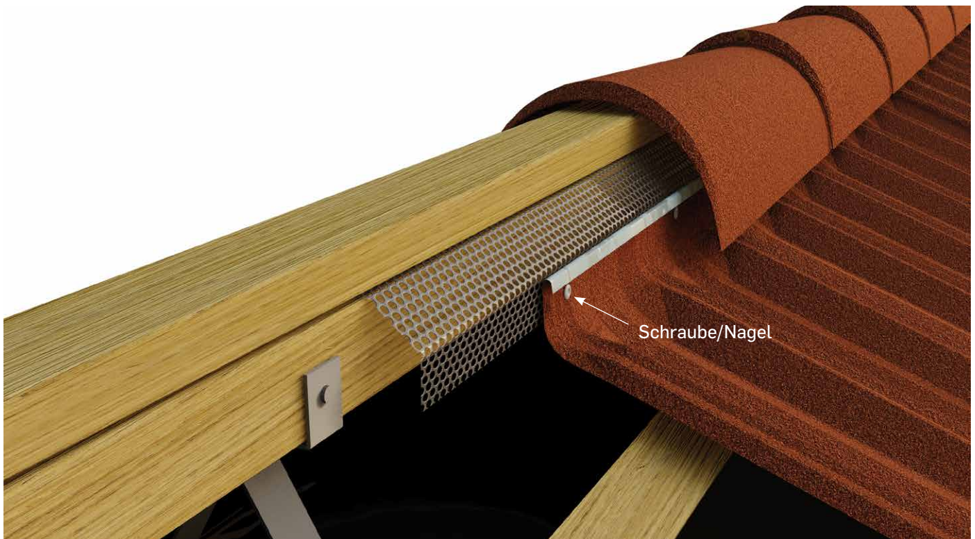
Option 1: Firstlatte mit Lüftungsgitter
